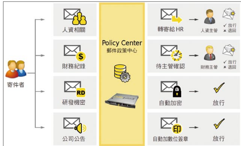
Cellopoint Email UTM郵件安全與管理的整合式解決方案採行邏輯。
